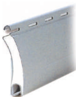
ART. 560.564 Profilo in acciaio di sicurezza 14x55 con poliuretano espanso. Peso x mq 10 Kg. ca.
