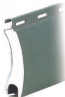
ART. 560.565 Profilo in alluminio 14x55 con poliuretano espanso ad alta densità. Peso x mq 5,04 Kg. ca.
