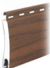
ART. 560.563 Profilo in alluminio 9x45 con poliuretano espanso. Peso x mq 2,9 Kg. ca.
