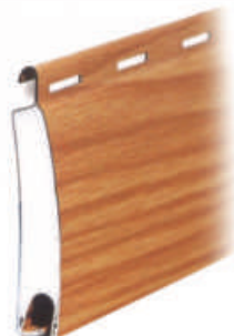
ART. 560.562 Profilo in alluminio 14x54 con poliuretano espanso. Peso x mq 3,6 Kg. ca.
